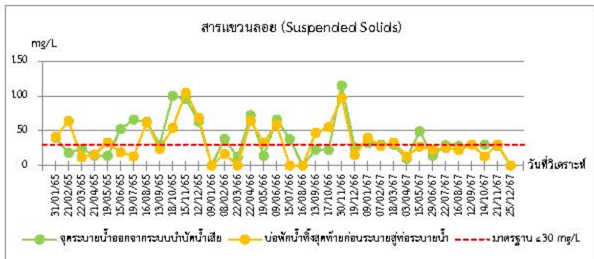
ภาพที่ 3.5.3-3 กราฟเปรียบเทียบผลการตรวจวัดคุณภาพน้ำทิ้ง บริเวณบริเวณจุดระบายน้ำออกและบ่อพักน้ำทิ้งสุดท้ายก่อนระบายออกท่อสาธารณะของอาคาร ระหว่างปี 2565 ถึง ปัจจุบัน
